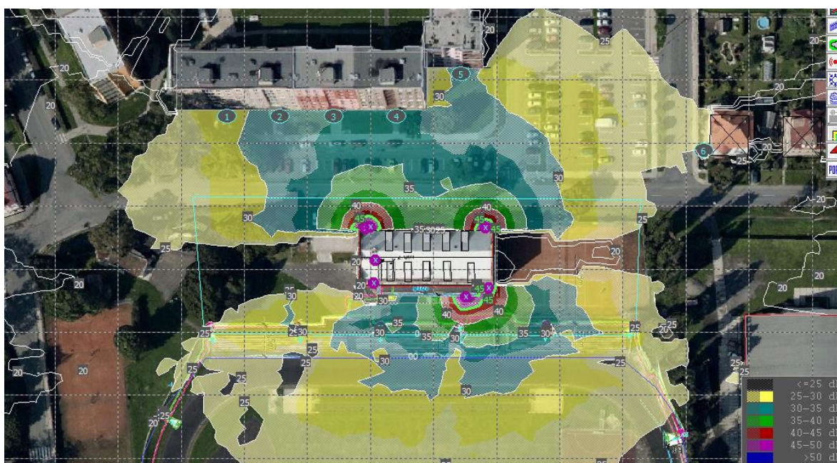
Obr. č. 6 vykreslení izofonových pásem v půdorysu na podkladové mapě satelitního snímku - výpočtová hladina 3 m
